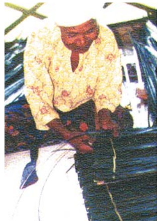
การเย็บจากมุงหลังคา
